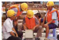
● 苏通大桥桩基础压浆效果CT检测
