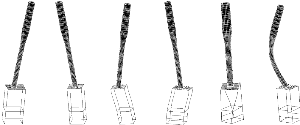
图 5 断路器前 6 阶模态振型
