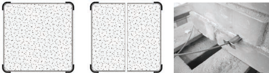
图 1 角钢及钢管穿筋
