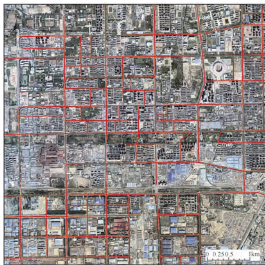
图 1 校正后的遥感影像和城市道路套合情况图
